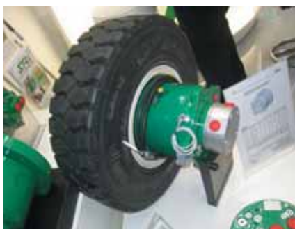
Рис. 2. Мотор-колеса с встроенным планетарным редуктором
