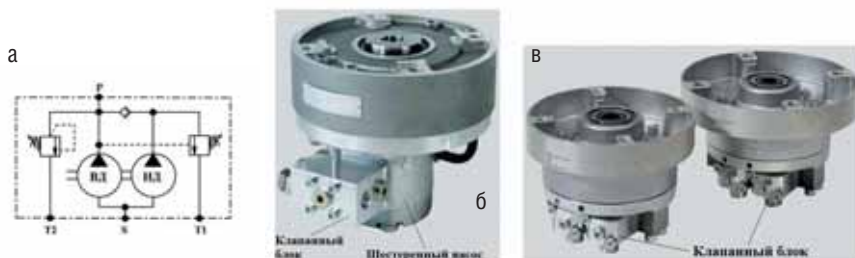
>>> Рис. 9. Гидросхема комбинированного насоса и внешний вид его исполнений (а, б, в) ВД – гидроконтур сверхвысокого давления; НД – гидроконтур низкого давления; S – порт всасывания; P – порт нагнетания; T1, T2 – порты слива
