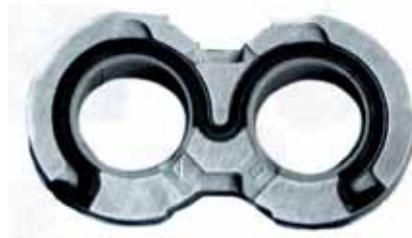
Рис. 8. Боковая крышка насоса с выемками
