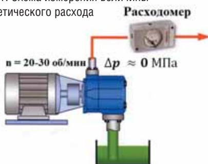
Рис. 2. Без нагрузки насос не развивает давления
