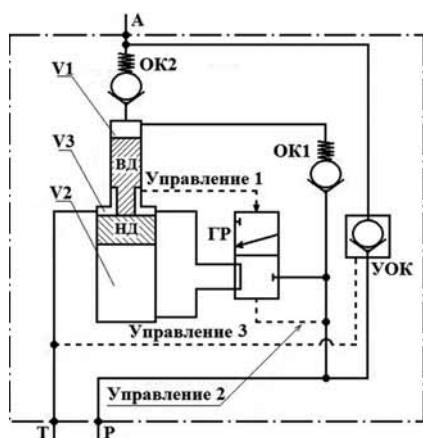
Рис. 3. Гидравлическая схема мультипликатора давления: Р – порт нагнетания; Т – порт слива; А – порт сверхвысокого давления; V1 – полость высокого давления; V2 – полость низкого (среднего) давления; V3 – промежуточная полость; ВД – поршень высокого давления; НД – поршень низкого давления; OK1, OK2 – обратные клапаны; UOK – управляемый обратный клапан; управление 1, 2, 3 – каналы гидравлического управления
