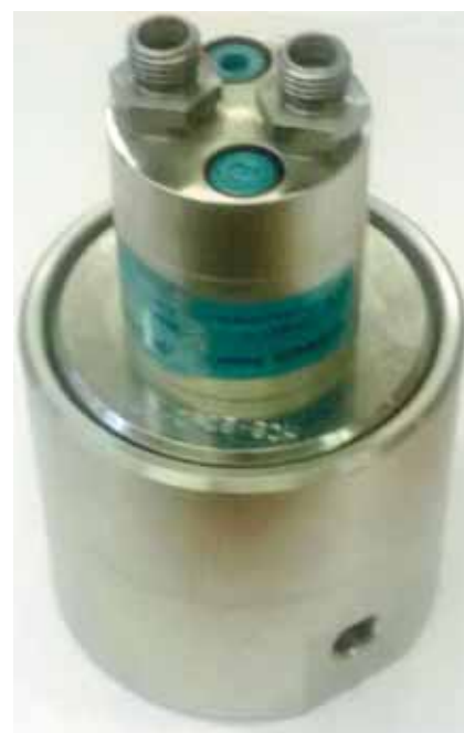
Рис. 2. Типовой малогабаритный мультипликатор давления
