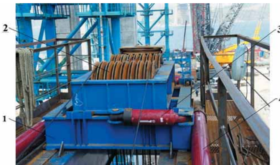
Рис. 5. Привод подвижной платформы подъема и позиционирования траверсы:
