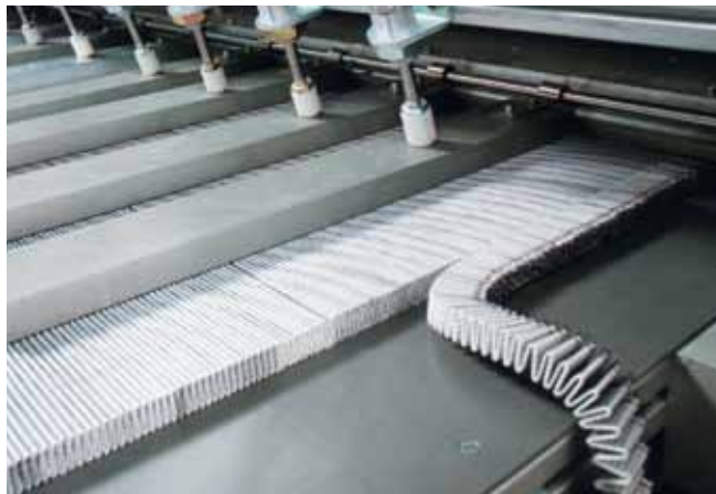
Процесс гофрирования фильтрующего материала
