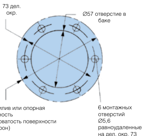
Сопряжение для стандартного и большого сапуна
